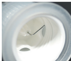
後針の折れ曲がり
