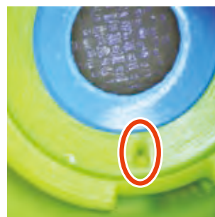
◎ プラスチック 部分の傷
